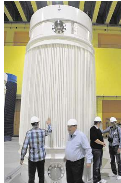
Mit Temperaturen von bis zu 20000 Grad. Im Plasma-Ofen werden radioaktive Stoffe vernichtet. Der Rest wandert in die Castor-Behälter. Fotos Kurt Tschan
