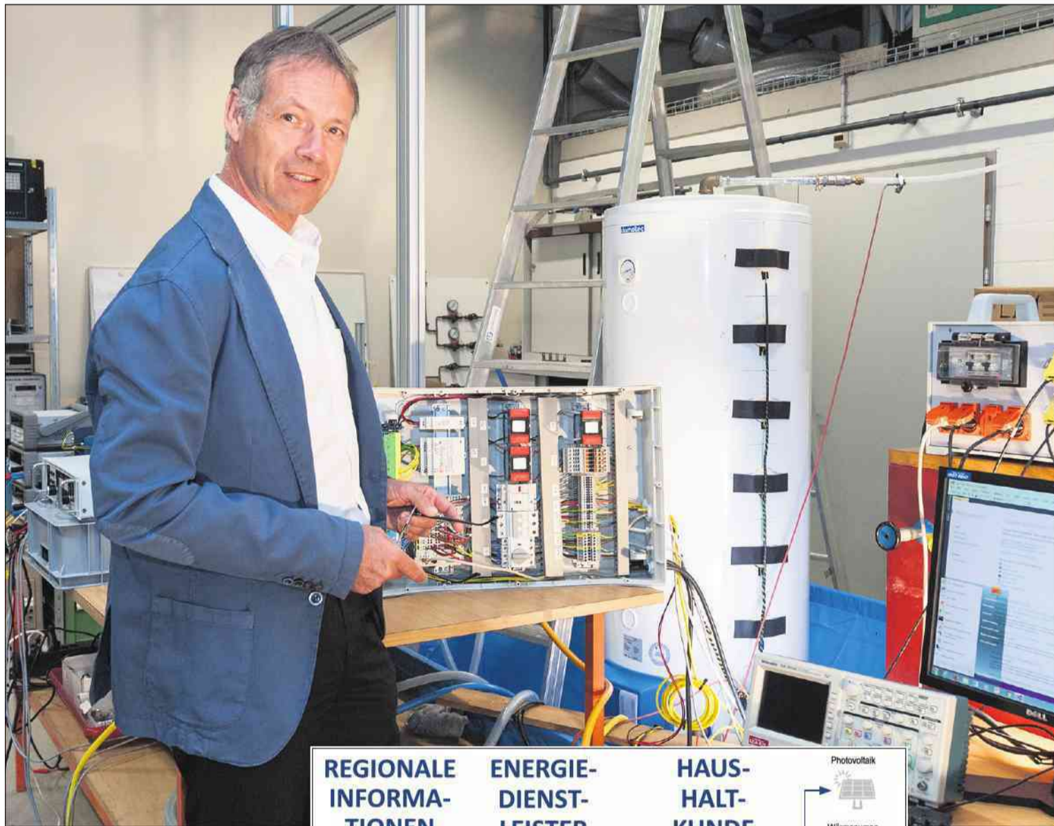
Der Ingenieur Stefan Roth von der Hochschule für Technik FHNW steht vor einem Prototypen des künftigen Hausmanagers. Dieses Gerät in Miniausführung soll in ein paar Jahren die Stromversorgung eines modernen Hauses intelligent steuern. (Foto: Sandro Nydegger)
